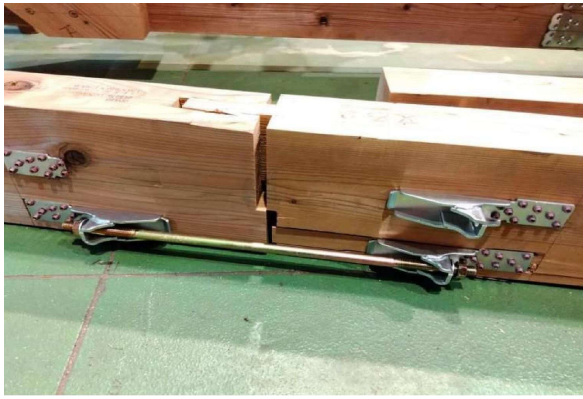
Fig1-11 弦材の接手部試験体の破壊状況(3) (ホールダウンエース)
