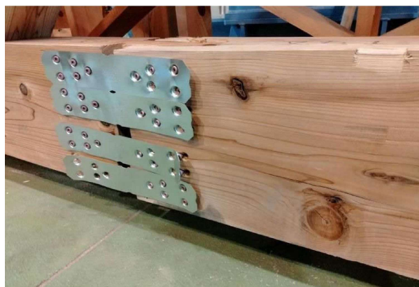
Fig1-10 弦材の接手部試験体の破壊状況(2) (オメガスリム)
