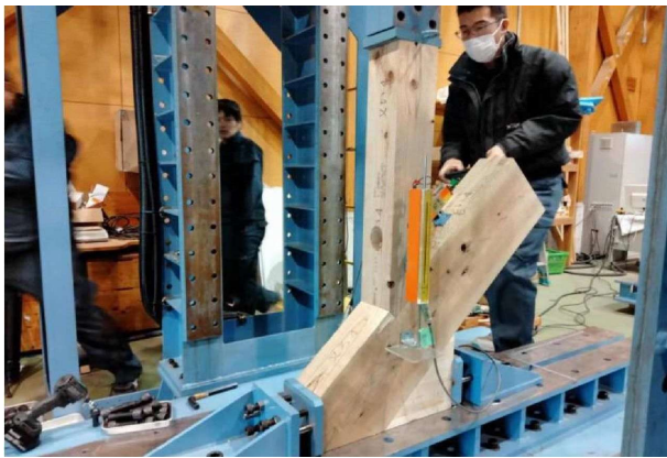
Fig1-13 弦材と斜材の接合部試験体の 破壊状況(1)
